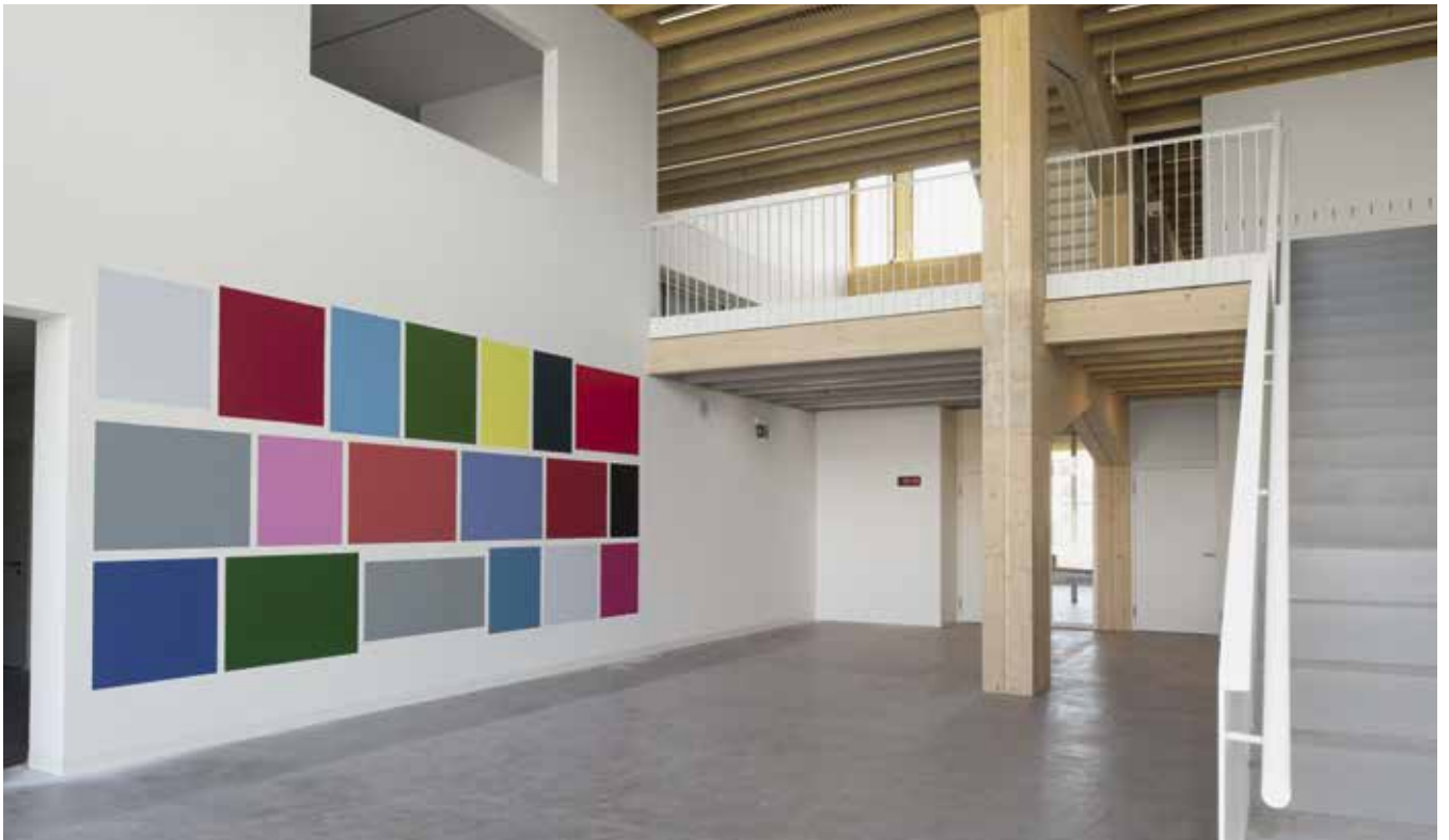
Au sol, la chape de type industriel est constituée de béton, auquel on a ajouté des particules de bois. Un contraste intéressant avec les murs blancs. Ci-dessus, un jeu de couleurs anime l'espace.
